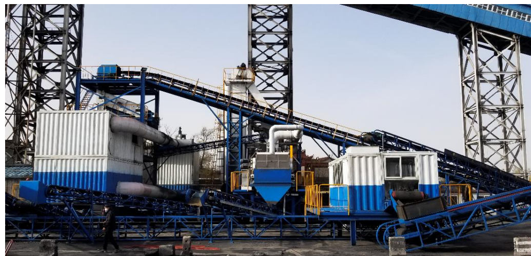
模块式干法重介质流化床选煤系统
