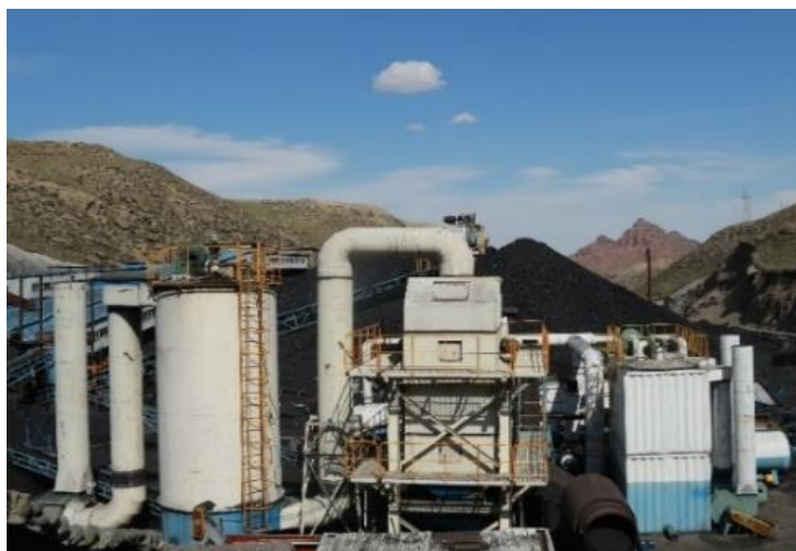
模块式干法重介质流化床选煤系统
