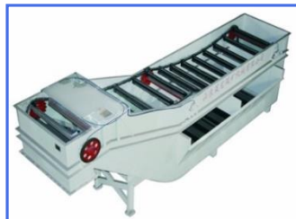
浅槽分选机 (最大 B=7925\text{mm} )
