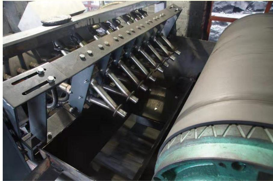
执行系统由空气压缩机（或压缩空气输气管）、储气罐、输气管、分气包、喷气嘴和电磁阀构成。其中喷气嘴和电磁阀每个通道对应设置一套。当判断为矸石时，经过控制系统设定的延时时间后，在矸石抛落过程中，控制系统打开高频气阀，高压气流冲出气阀并击中抛落过程中的矸石，使其偏离原来的轨迹，落入矸石料斗。没有被击打的煤块按原轨迹自然抛入煤斗。
