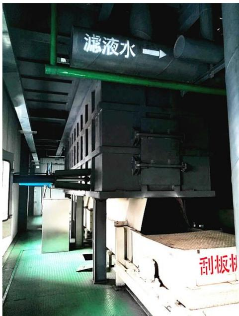
将原压滤机机下溜槽改成滤饼缓冲仓，仓内滤饼卸料采用可调速的油缸推杆阀门匀速推至仓下刮板输送机后转运至主洗精煤皮带，完成滤饼的均匀掺混
