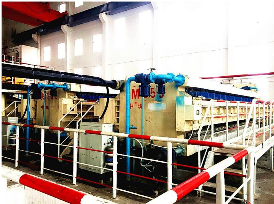
穿流压滤机具有**完整有效给料、压榨、介质置换（风干）三段过滤**，是保证滤饼含水率远低于传统过滤设备的根本原因。尤其是**侧外进料**的独特滤板设计，保证吹干有效，极大的降低了滤饼含水率。
