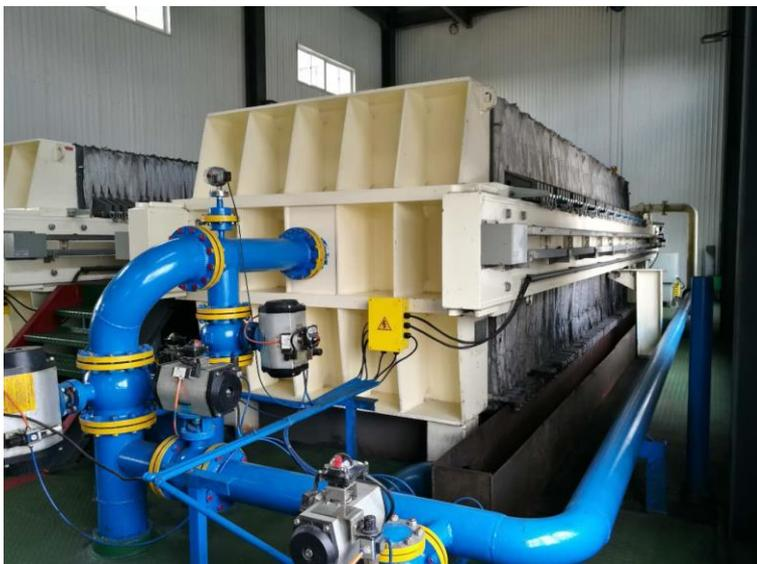
传统隔膜压滤机采用中间进料，形成滤饼后，无论从滤饼的那一侧向对面吹干，压缩空气都将通过给料口直接串通，导致短路而无法吹干滤饼。
