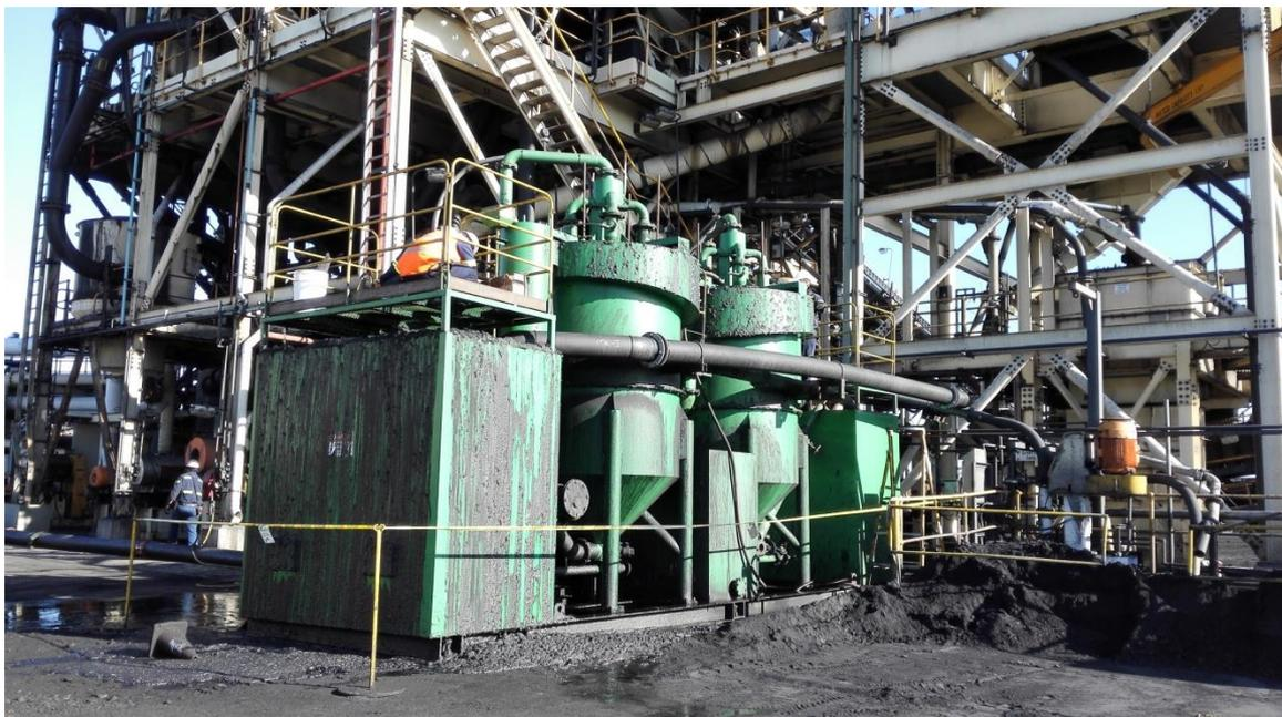
在澳大利亚昆士兰州middle mount 煤矿选煤厂做工业性实验。测试设备的性能、安全性、适应性、可靠性。其分选效果达到同厂应用的JAMSON浮选机指标。
