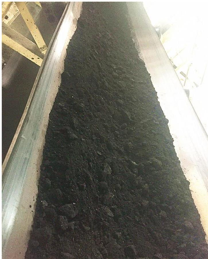
在粒度组成为< 325目含量在30%左右的长焰煤，原生煤泥脱水后滤饼水分在19.30%--22.87%之间，滤饼松散易碎，容易掺混。而同厂应用的传统隔膜快开压滤机滤饼水分为26%-28%。
