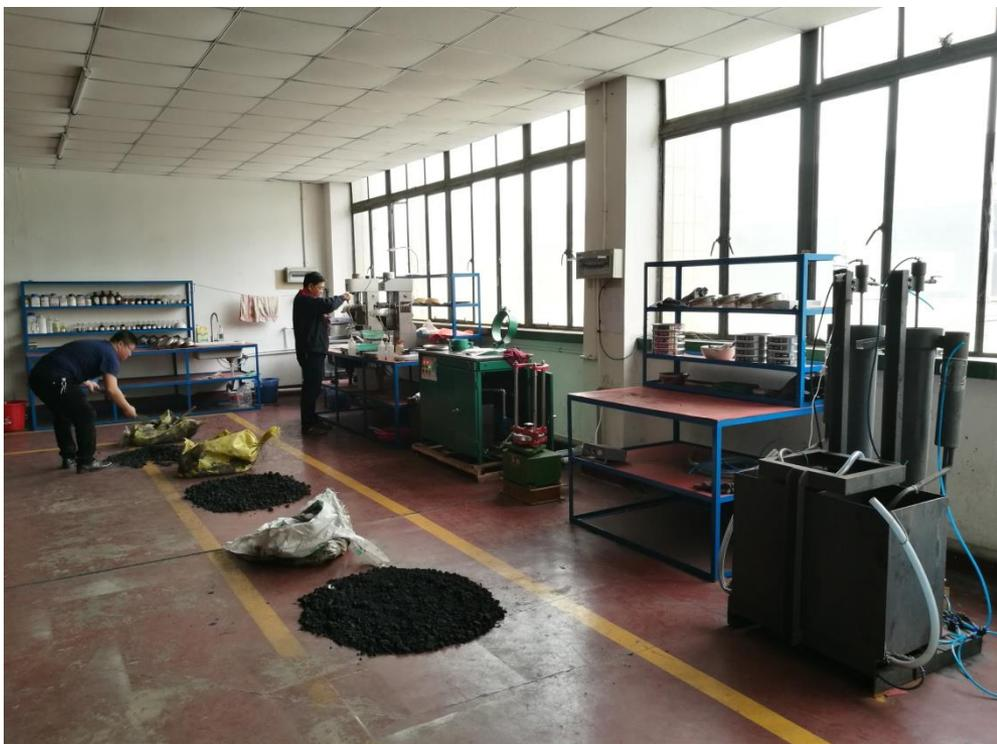
公司建有煤泥分选处理实验室，可进行多种煤样的筛分、小浮沉、浮选、过滤、压滤等多种煤泥分选试验。
