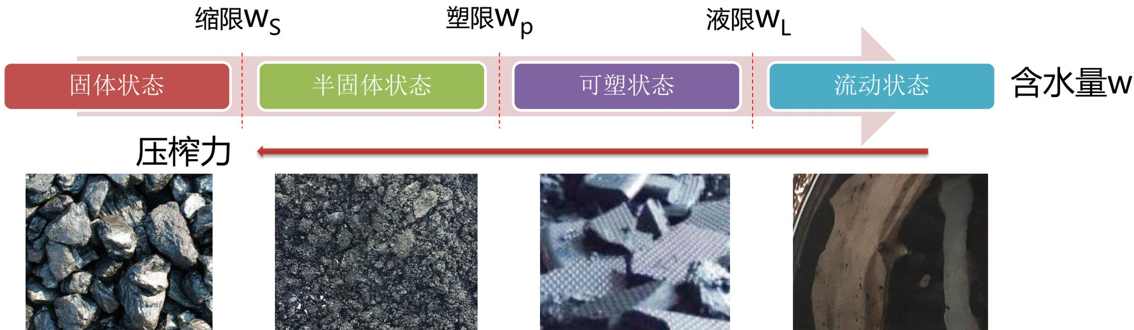
细小颗粒周围形成的电场，吸引水分子形成粘结水膜，造成物料的可塑性。因此，对于含水量越大的物料，其塑性越强，直至达到流动状态；而含水量越小，则其越坚硬。
